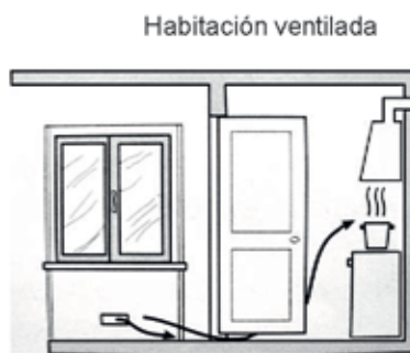
Ampliación de la ranura de la ventilación entre la ventana y el suelo.
