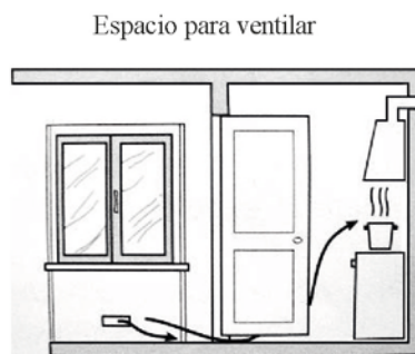
Ampliación de la ranura de ventilación entre la ventana y el
