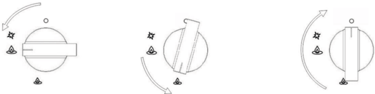
Quemador ENCENDIDO, llama alta Quemador ENCENDIDO, llama pequeña (modo de ahorro) Quemador apagado
